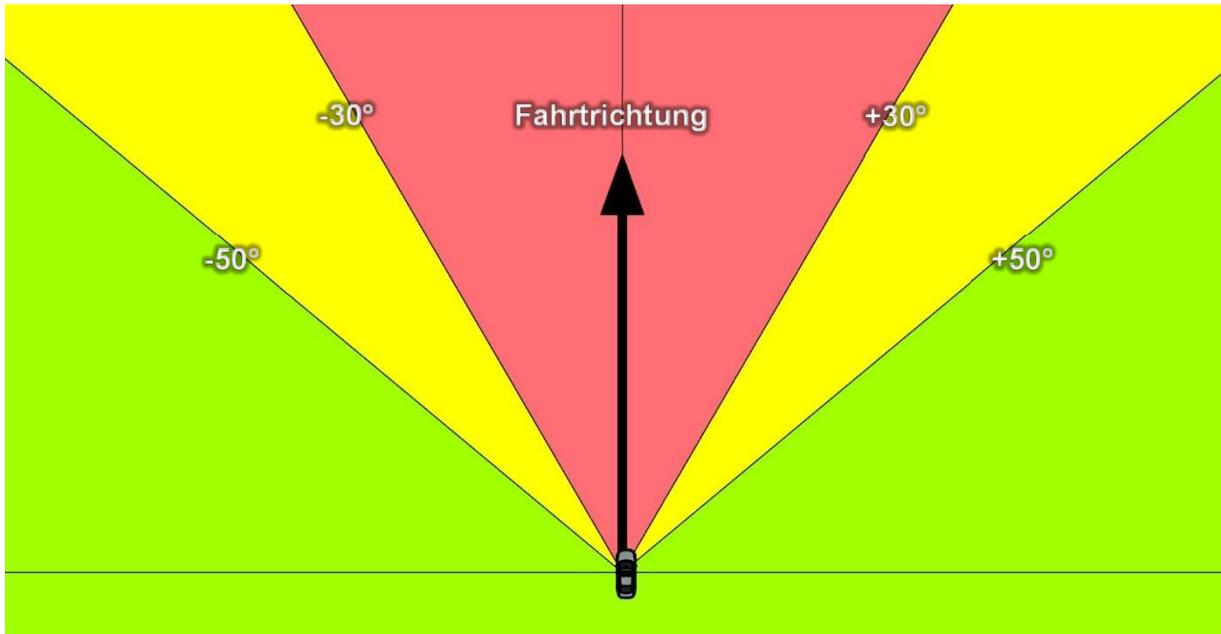
Abbildung 10: Definierte Sichtfelder eines Fahrzeugführers
