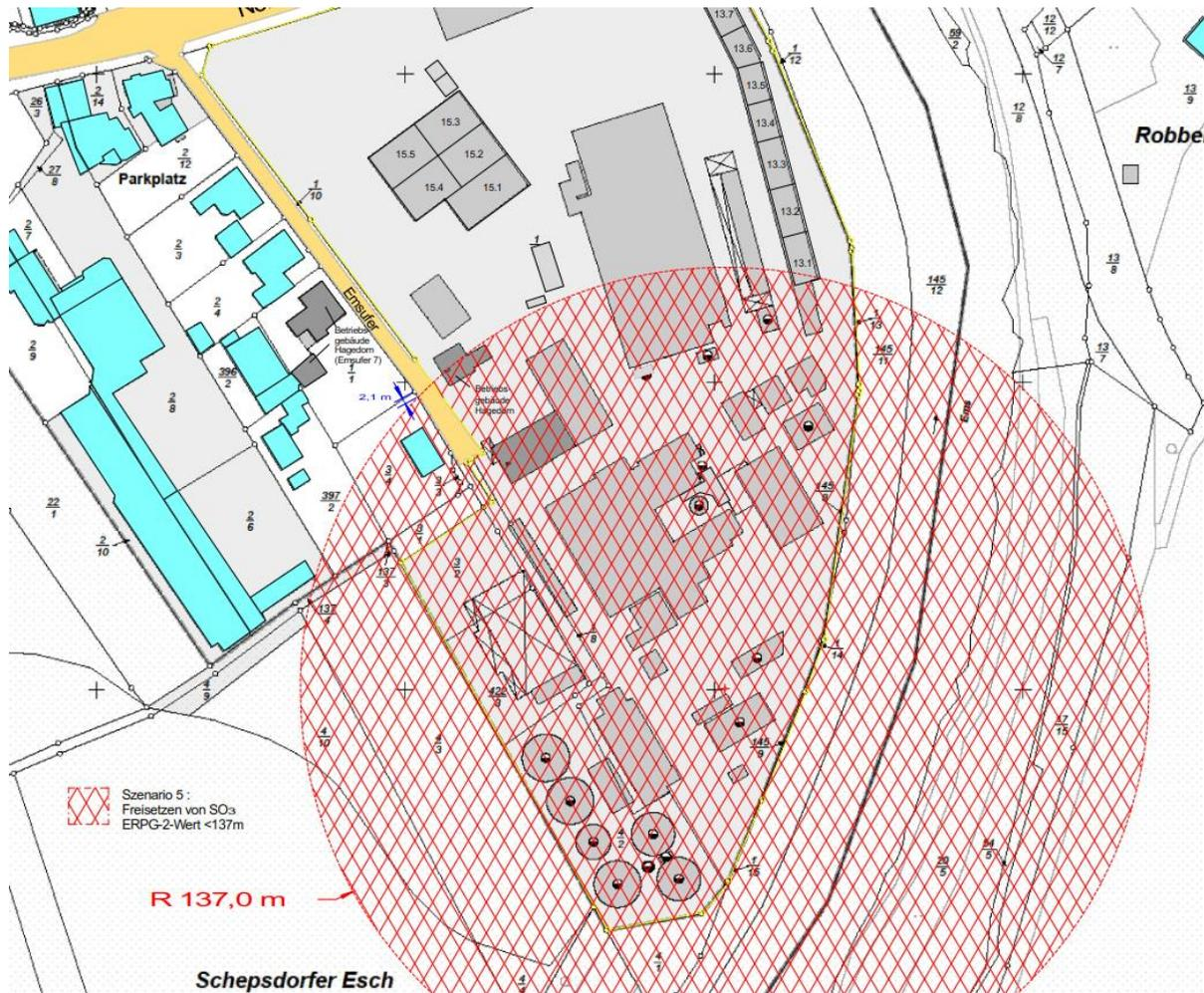
Abbildung 13: Szenario 5 – Freisetzen von SO<sub>3</sub> (ohne Maßstab)
