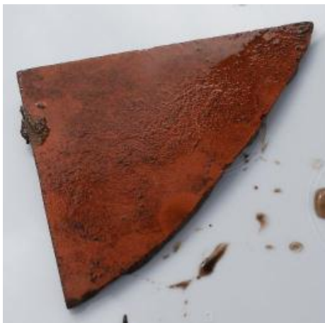
Kunstschieferplatte aus Faserzement, rot (Probe 3):
