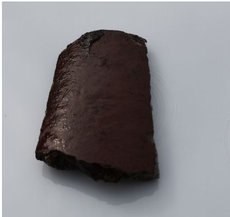
Faserzementplatte, rot-braun (Probe 1):
